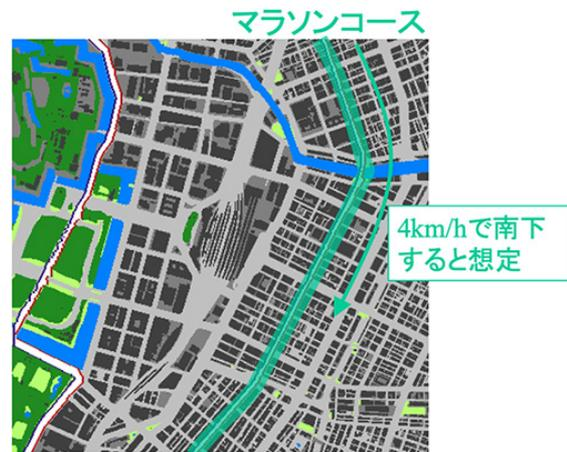
図5：東京オリンピック2020のマラソンコース沿い(当初案。このシミュレーションの後、札幌での開催に変更された。)の通りを毎時4kmで南下すると想定して、歩行者が晒される熱環境変数(気温、湿度、風速、日射量)の時間変化を算出した。
