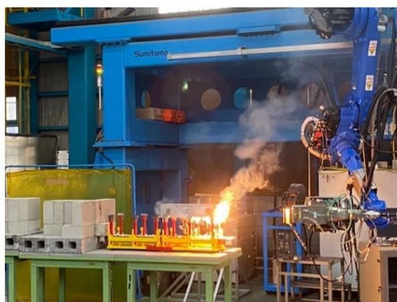
図 1: 高出力レーザーによるコンクリートの溶断実験
