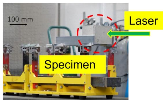
図 3: コンクリート供試体の設置状況
