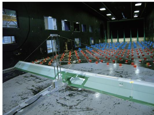
図2 盛土上の流れの風洞実験の様子
