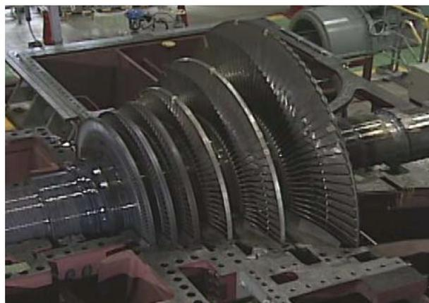
図 1.1 発電用大型蒸気タービン低圧ロータと下半車室<sup>1)</sup>
