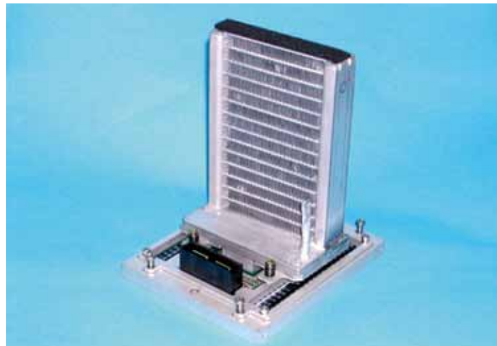
沸騰型ヒートシンク(冷却器)を搭載した計算プロセッサ。
