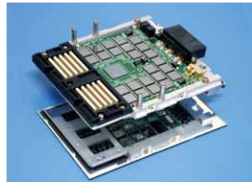
主記憶ユニット(MMU)パッケージ。中央のメモリ制御用LSIを囲むようにメモリ素子が並ぶ。
