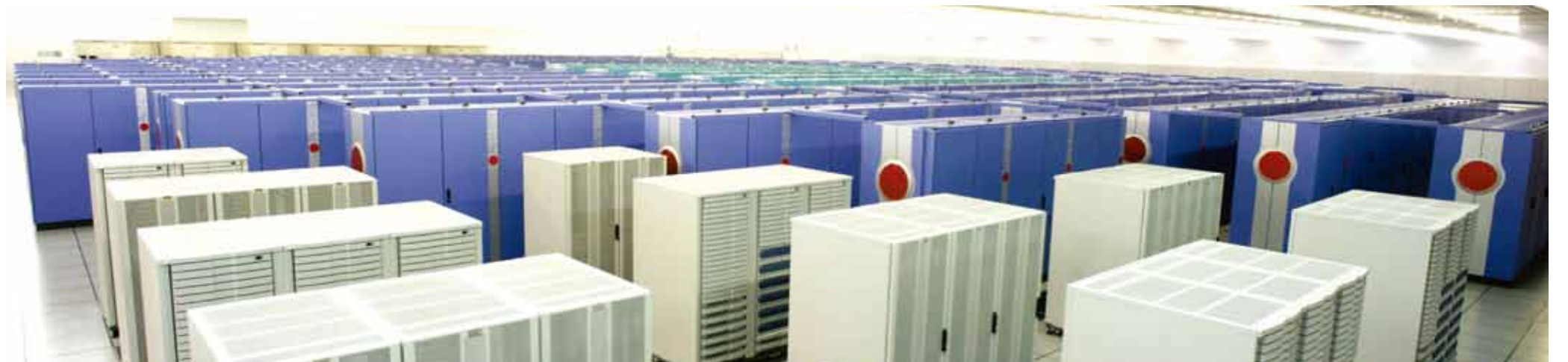
←地球シミュレータ本体の配置図。中央の結合ネットワークの周りに計算ノード(320筐体)が並び、さらに外側に磁気ディスク、カートリッジテープライブラリシステムが配置されている。
