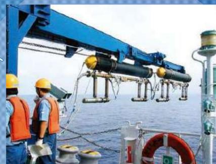
エアガンはいわば、海中に設置する大きな「スピーカー」です。圧縮空気を放出して、人工的に低周波音波を作り出します。
