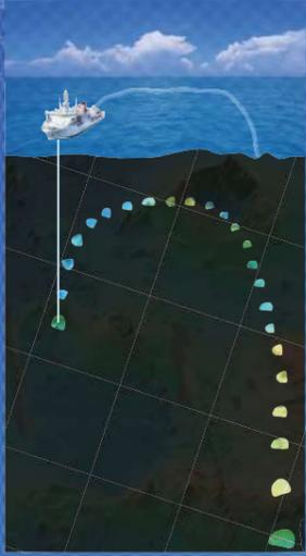
音波を使って海の深さを調べる技術が登場する以前は、錘をつけたロープを海中に垂らして、海底に着くまでの長さを測る「錘測法」が使われてきました。とても単純な方法ですが、この方法では広大な海を「点」でしか調べることができず、水深数千メートルを超えるような場所では1回の観測に数時間もの時間が必要で、大変な労力を要するものでした。
