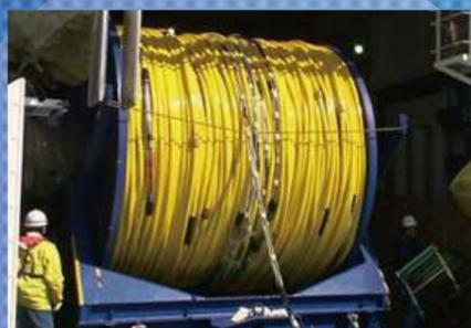
ウインチに巻かれたストリーマケーブル。ストリーマケーブルは、音波を受振する「マイク」のような働きをします。たくさんの受振器が装備されたケーブルの総延長は、約5,000mにも及ぶことがあります。
