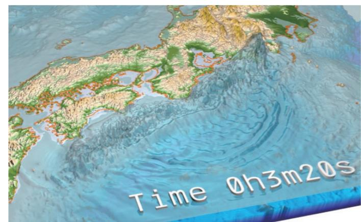
図3. 連成シミュレーションにより求められた、南海トラフ巨大地震の強い揺れ、地殻変動、津波。地震発生から3分20秒後の地面・海面の震動と、海底地殻変動により発生した津波が海面を広がる様子を示す。
