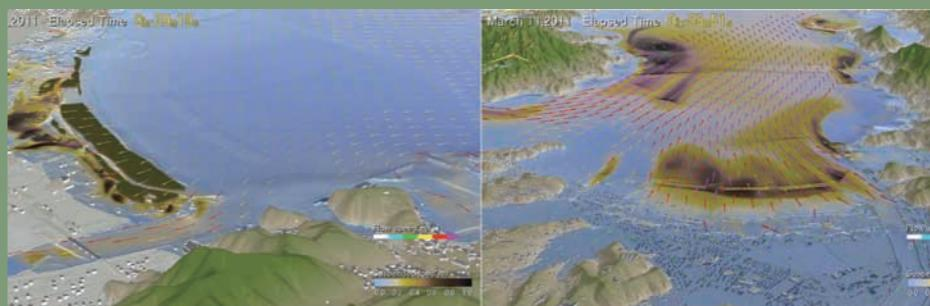
図4. 陸前高田市を襲った津波第一波による大規模な土砂移動（左図：押し波、右図：引き波）
