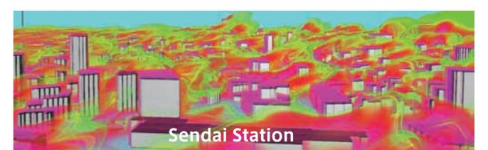
図 5. 水平格子間隔 3 m のビル解像モデル (DS3) による海風侵入時 (2007 年 6 月 19 日 13 時) の仙台駅周辺の気温の分布
