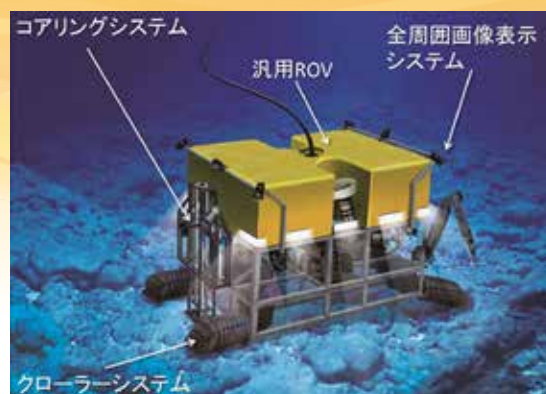
汎用ROVを利用した「高効率海中作業システム」概要
