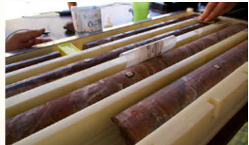
オマーンオフィオライト基底部の炭酸塩岩化した変かんらん岩(listwanite)
