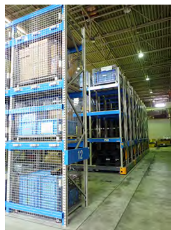
横須賀本部海洋工学実験場に設置した移動式電動ラック
