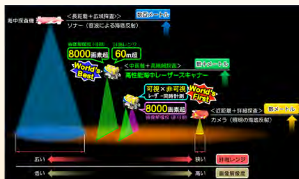
図 従来の海底可視化技術に対する高性能海中レーザースキャナーの位置づけと本発表の成果
