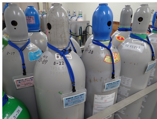
タグによる高圧ガスの管理 (横須賀本部)
