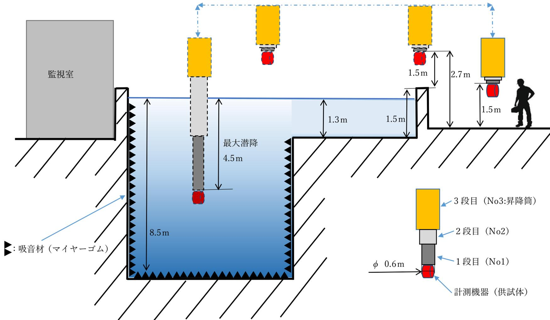
超音波水槽 計測機器位置検出制御装置の断面概要図
