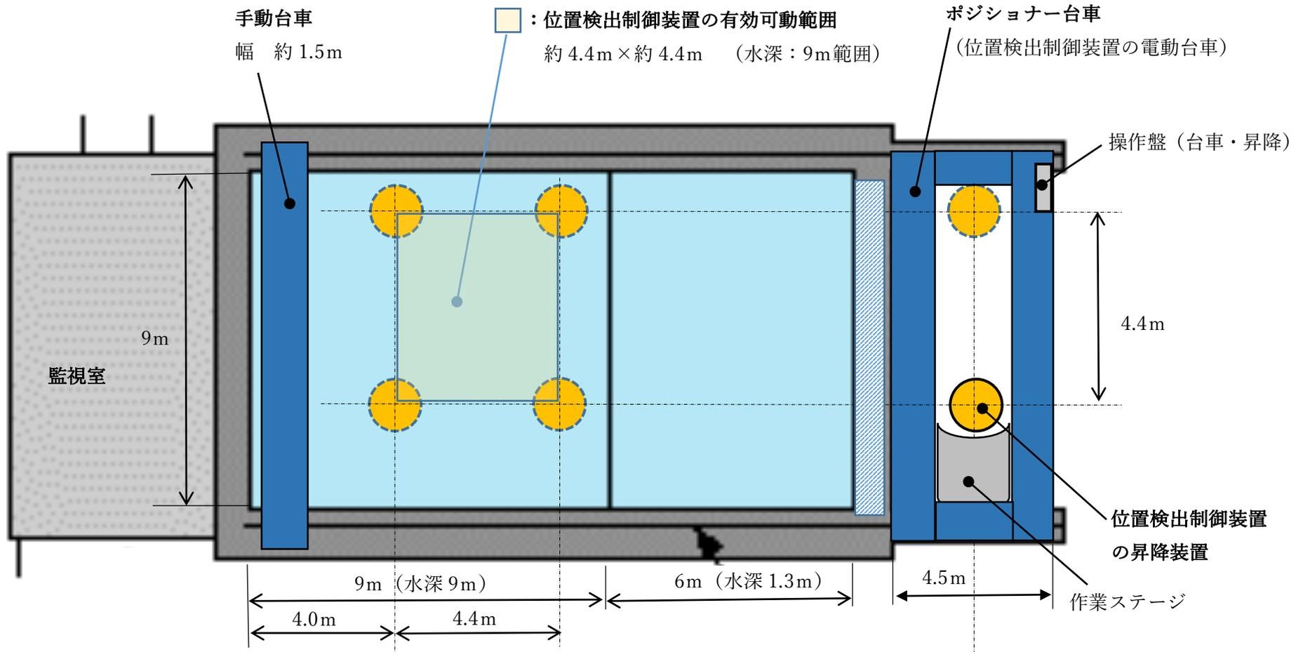
超音波水槽 計測機器位置検出制御装置の平面概要図
