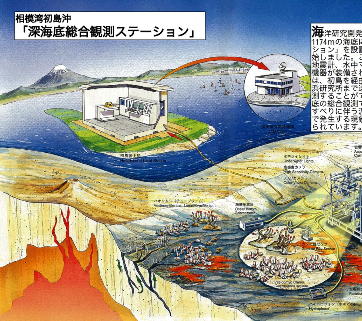
伊洋研究開発機構は、1993年に水深 1174mの海底に「深海底総合観測ステーション」を設置して、長期連続観測を開始しました。これには、ビデオカメラ、 始しました。これには、ビデオカメラ、 地震が装備されています。観測データ 機器が装備されています。観測データ 横振辺所まで送られ、リアルタイムで親 に研究所まで送られ、リアルタイムで りに伴う泥流を捉えるなど、深海底 で発生する現象について多くの知見が得 られています。
