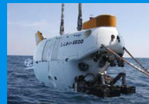
有人潜水調査船「しんかい6500」 人を乗せて水深6500mまでくもれる潜水船です。
