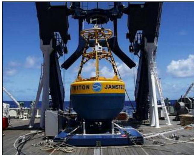
Aフレーム下でセンサーが取り付けられ、通信テスト中のトライトンブイ
