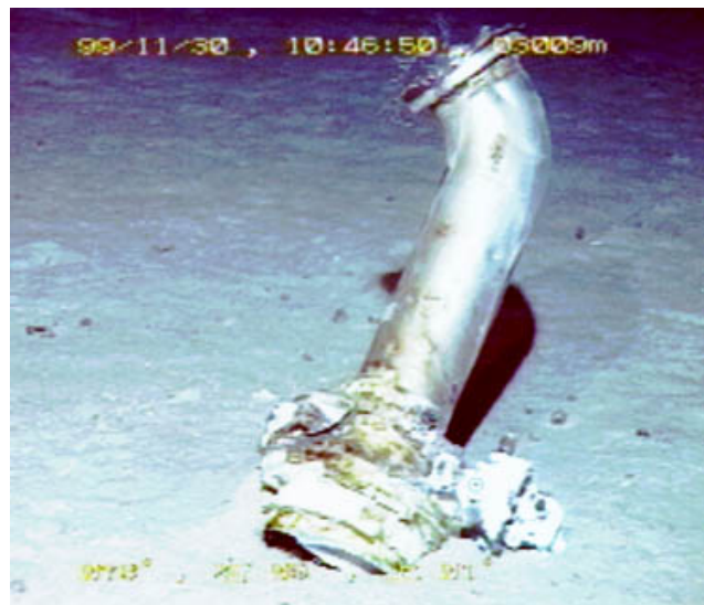
写真1 1段液体水素注排液配管の一部の画像 1999年11月30日(火)発見
