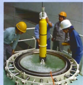
高圧実験水槽で試験中のアルゴフロート
