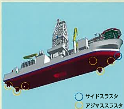
・サイドスラスト 2,550kW ・アジマススラスト 360度回転できるプロペラ 4,200kW×6
