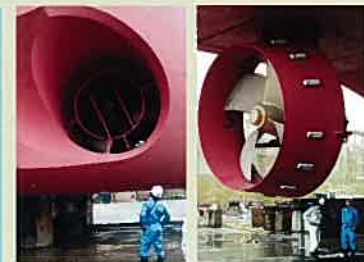
・サイドスラスト 2,550kW ・アジマススラスト 360度回転できるプロペラ 4,200kW×6
