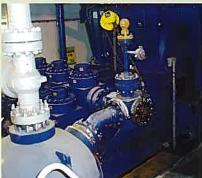
マッドポンプ 泥水に圧力を加えて海底に移送する装置
