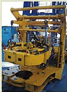
ハイドラリックラフネック パイプ類のねじの締め付け/戻しを行う。
