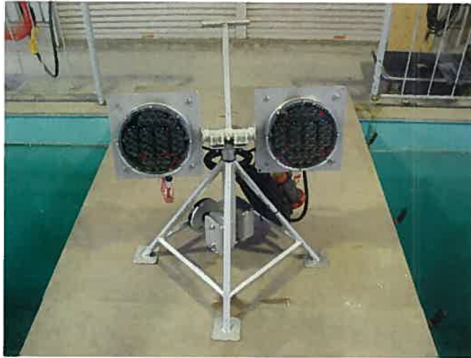
LED 水中照明システム
