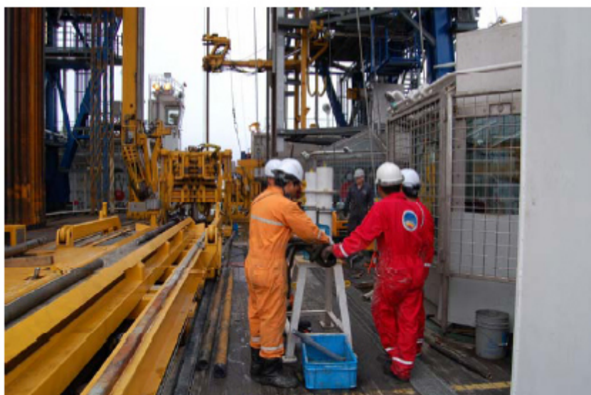
(図二) 船上作業風景(船上に上がってきた試料(コア)回収の状況)
