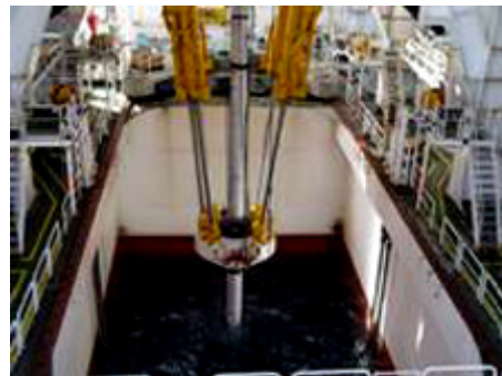
(写真-3) 左側：荒天時のムーンプール※1の状況（6本の黄色いライザーテンショナーが中央のライザーパイプを保持しているところ） 右側：平静時のムーンプール ※1：船体の中央にある海への開口部（幅12m×長さ22m）ここを通過して船上からBOP等が降下される
