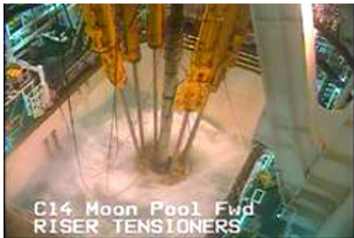
(写真-3) 左側：荒天時のムーンプール※1の状況（6本の黄色いライザーテンショナーが中央のライザーパイプを保持しているところ） 右側：平静時のムーンプール ※1：船体の中央にある海への開口部（幅12m×長さ22m）ここを通過して船上からBOP等が降下される
