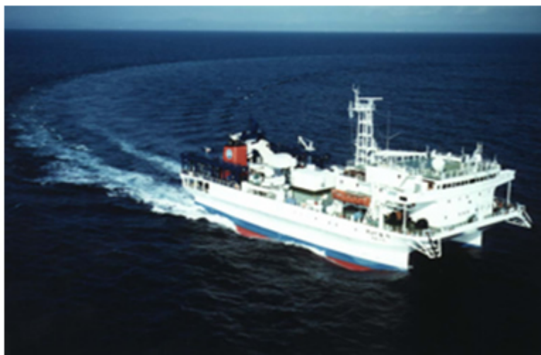
写真1：海洋調査船「かいよう」。両舷にそれぞれエアガンを4機ずつ備える。
