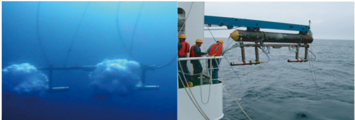
写真3：エアガン装置。左は、水中で音波を発振している様子。右は、エアガンを投入している作業風景。黒い長いものはフロート、フロートの下に吊られている2本の銀色の筒がエアガン装置。
