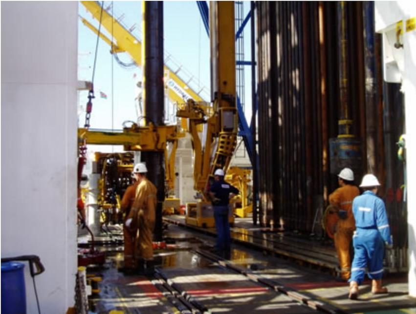
写真-2 ケニア沖での掘削作業。ケーシングパイプの設置
