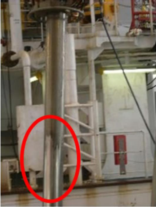
写真-4 表面コーティングの剥離が進行した状況 シリンダーロッド上部のコーティングが剥離
