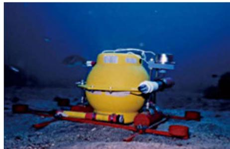
写真2: 海底に設置された海底地震計。
