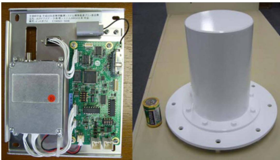
図3：観測ブイ用PMT-HD(左：本体、右：アンテナ)
