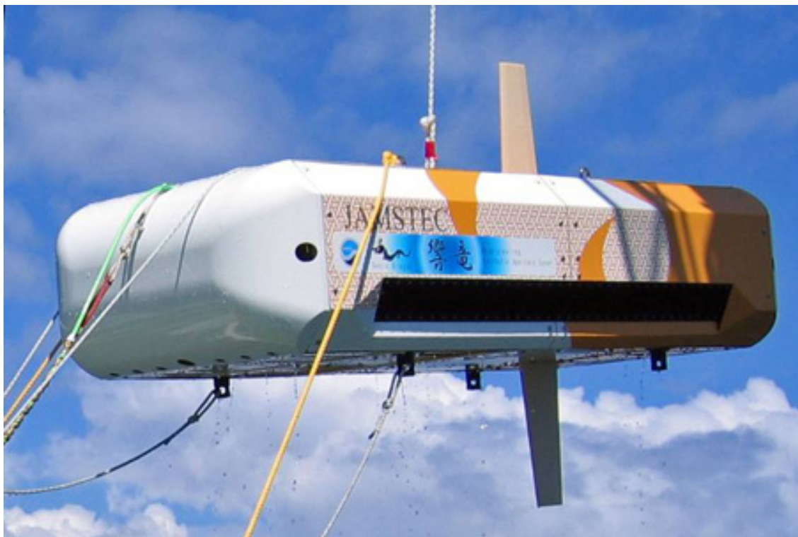
図1 調査で使用した合成開口ソナーを搭載した曳航体。 全長2.3m、全幅1.2m、総重量約100kg
