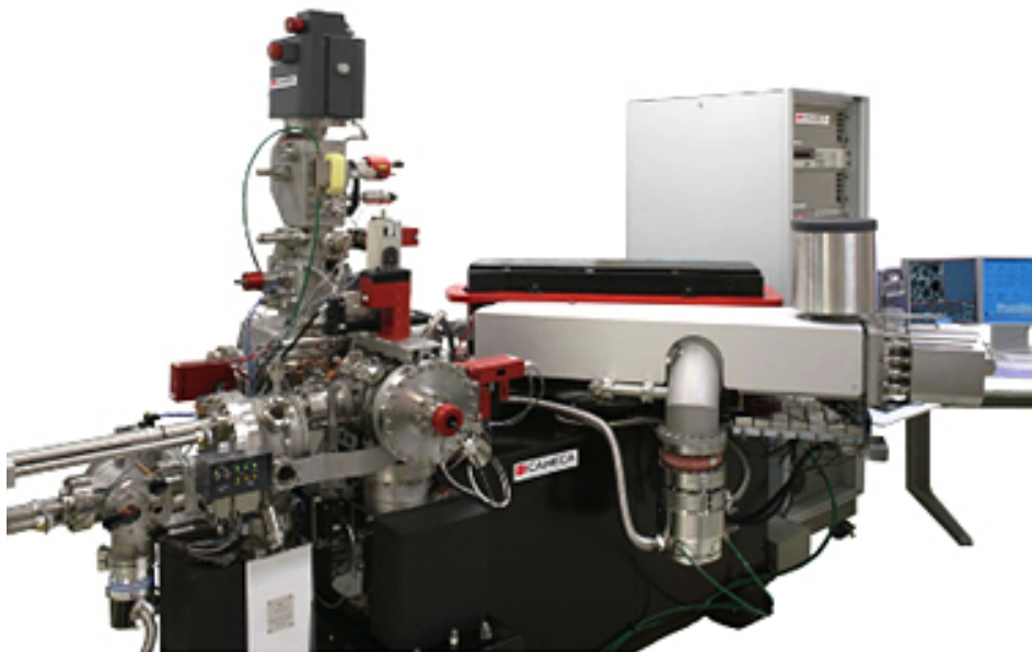
図1. 超高解像度二次イオン質量分析計（NanoSIMS）。
