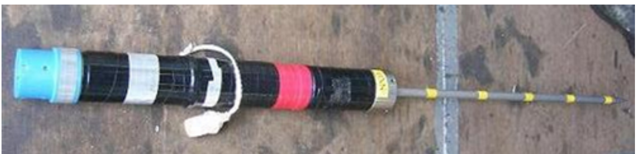
【参考】 Stand Alone Heat Flow Meter: 長さ60 cmのプローブ中に高精度温度計が等間隔に5つ付いており、無人探査機や有人潜水船のマニピレーターを使って地中にプローブを挿すことで温度勾配を測定する。
