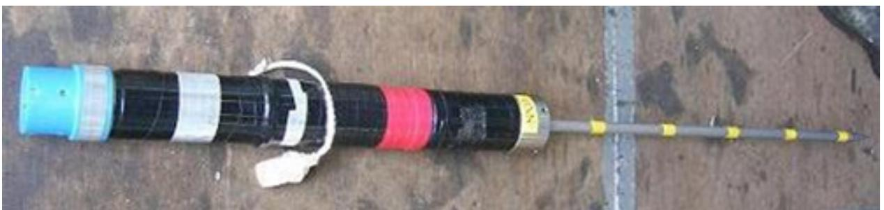
【参考】 Stand Alone Heat Flow Meter: 長さ60 cmのプローブ中に高精度温度計が等間隔に5つ付いており、無人探査機や有人潜水船のマニピレーターを使って地中にプローブを挿すことで温度勾配を測定する。
