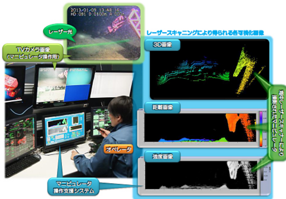
図2 レーザースキャニング画像を用いたマニピュレータ操作支援システム
