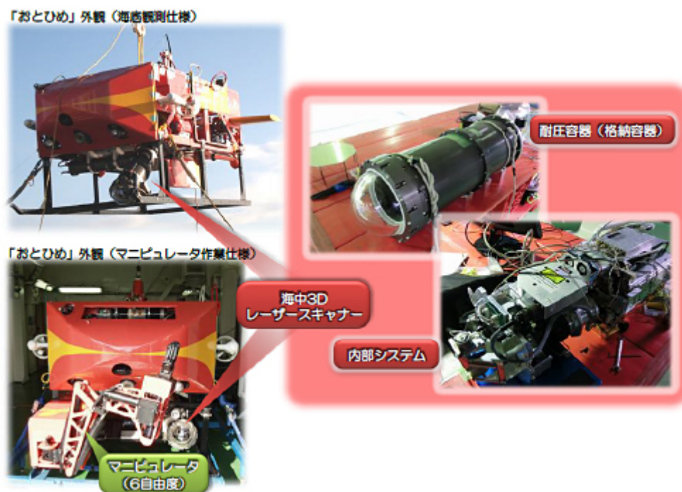
【参考】海中3Dレーザースキャナーを搭載した探査機「おとひめ」
