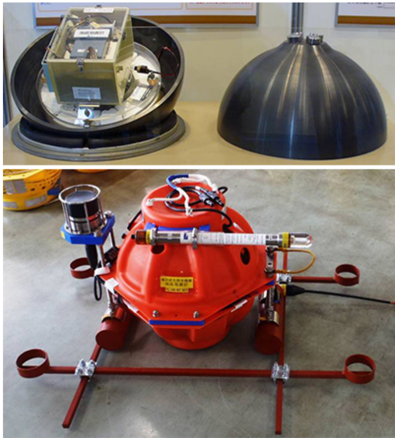
図7 セラミックス製の球型耐圧容器（上）と超深海型海底地震計（下）。上の写真中左は下半球に地震計を配置した状態、右は上半球で上部に貫通孔が設けられている。
