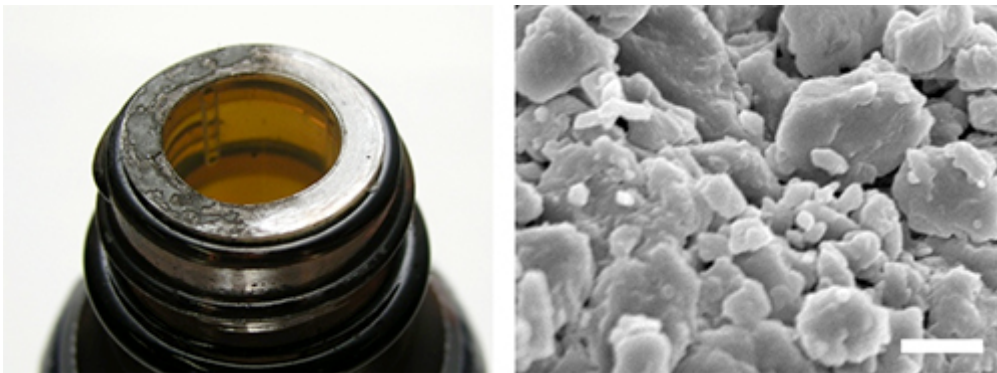
図7. 試薬ビンの口に付着したC 60 （左）とその電子顕微鏡観察像（右、スケールバーは500ナノメートルを表す）
