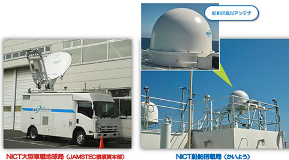
【参考4】「きずな」大型車載地球局と船舶搭載局
