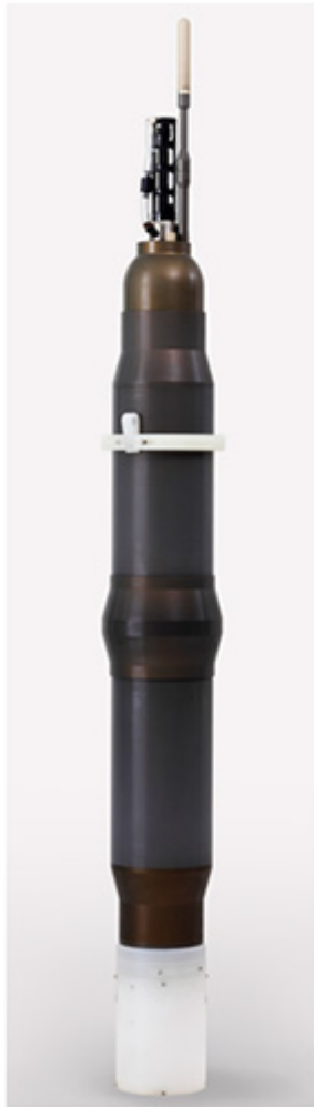
図1：（写真左）深海用プロファイリングフロート「Deep NINJA」。全長は210cm、重量は50kg。上部に水温・塩分センサと通信アンテナがある。（写真右）「Deep NINJA」の投入地点。
