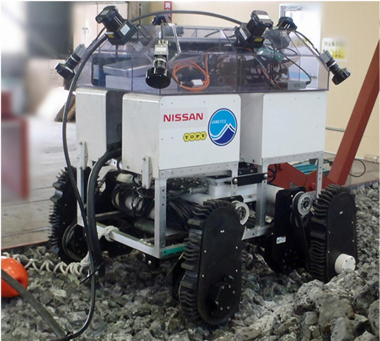
図2 ROV用画像システム試験機。4つのカメラと4つのレーザーレンジファインダーからの情報を処理する新たなアラウンドビューモニター技術を用いた装置（画像上）を、フリッパー式クローラを持つ小型ROV（画像中央から下）に搭載して試験を実施した。
