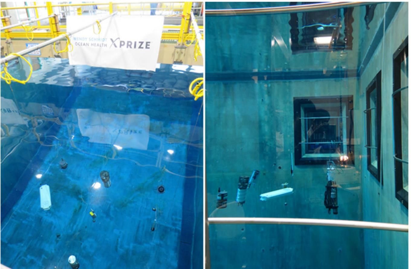
図6,7 モントレー湾水族館研究所プール内に吊り下げられた各チームのpHセンサ
