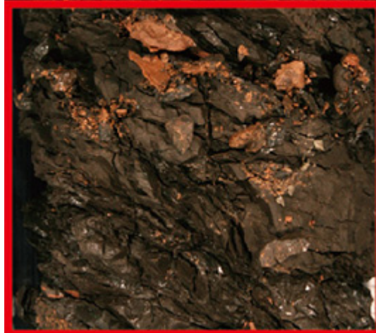
図2 (A) 鱗片状構造が発達したプレート境界断層。今回、赤四角で囲った部分から採取した試料を用いて摩擦実験を行った。実験に用いた2種類の試料。(B)鱗片状構造と平行に整形した試料。(C)粉末状試料。
