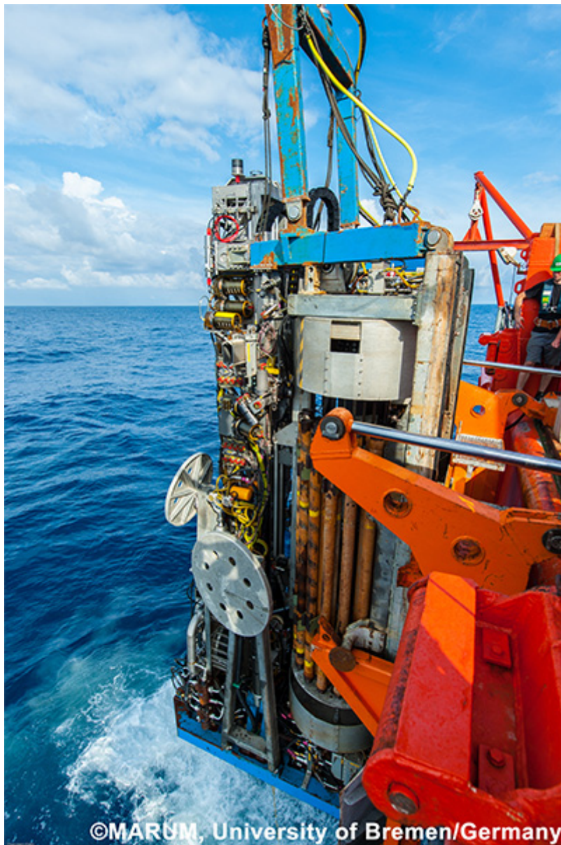
図3 ブレーメン大学海洋環境科学センター（MARUM）が所有する海底設置型掘削装置「MeBo（ミーボ）」。掘削装置が収められたコンテナ（写真中央）をケーブルで海底まで下ろし、船上からリモートコントロールによって掘削を行う。（写真：MARUM, University of Bremen/Germany）
