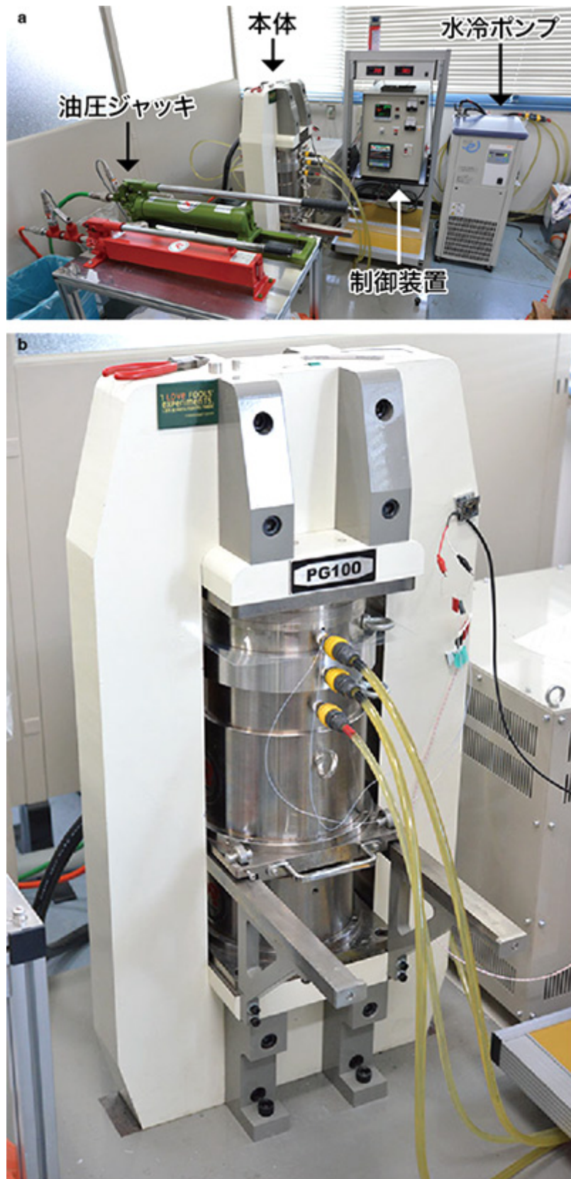
図4：複数相飽和実験に用いたピストンシリンダー型高温高压発生装置（京都大学所有）。
