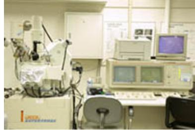
電子線を試料に照射すると、試料から特性X線、二次電子や反射電子等が放出されます。特性X線は元素によって固有の波長を持っています。このX線を様々な検出器で検出することにより、試料の元素組成の濃度や元素の分布などを調べることができます。また特性X線の検出と同時に試料から発生する二次電子、反射電子を検出することにより、分析点を確認できます。JAMSTECでは主に鉱物の元素組成やその分布を調べるのに使われています。
