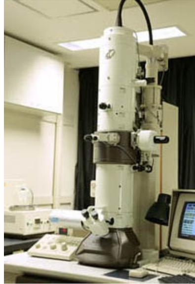
電子線を試料に照射し、試料を透過した電子の分布像を蛍光板上で観察することができます。また必要に応じてフィルムやCCDカメラにて記録することができます。主に試料の内部構造を観察することができます。電子線は物質を透過する能力が低いいため、試料を薄く(100ナノメートル(1ナノメートル=百万分の1ミリメートル))しなければなりません。JAMSTECでは主に深海生物の細胞や細菌の鞭毛を観察するために使われます。
