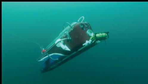
ハイビジョンカメラを搭載した潜航中の「PICASSO(ピカソ)」。本体は長さ2m、幅0.8m、高さ0.8m。母船とは直径1mmの細い通信用光ケーブルでつながられているだけなので、海流などの抵抗を受けにくく、生物を追跡しながら調査するのに適している。最大潜航深度は1,000m(撮影:新田末広)
