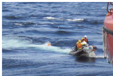
漂流型セジメントトラップ観測装置を曳航して、「みらい」の後を追う作業艇
