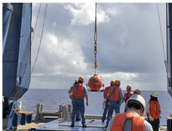
海底地震計を海底に設置する船上作業を行っている様子
