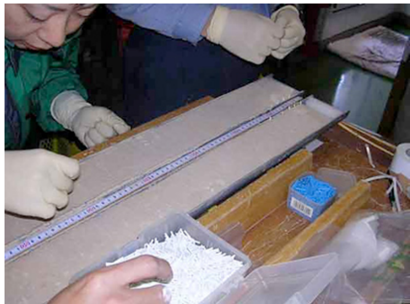
ピストンコアリングで採取された石灰質ナノ軟泥
