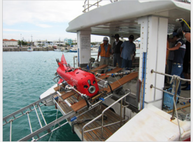
ピカソの着水揚収の試験。今回初めてクレーンを持っていない船を使って、ピカソの着水揚収を行いました。昇降台を傾けてロープで引っ張りながら少しずつ海面に降ろしていきます。この運用方法の確立により、世界中どこでも現地の船に昇降台を設置することでピカソの調査ができるようになりました。来年はオーストラリアのグレートバリアリーフでの調査を計画しています。
