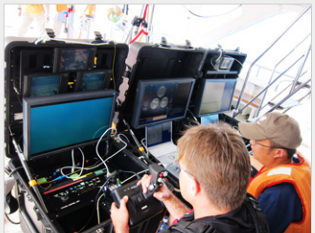
3つの画面を確認しながらピカソを操作していきます。左から、ピカソが撮影している映像をリアルタイムで映す画面、ピカソの向きや動きを表示する画面、ピカソの位置を確認する画面。
