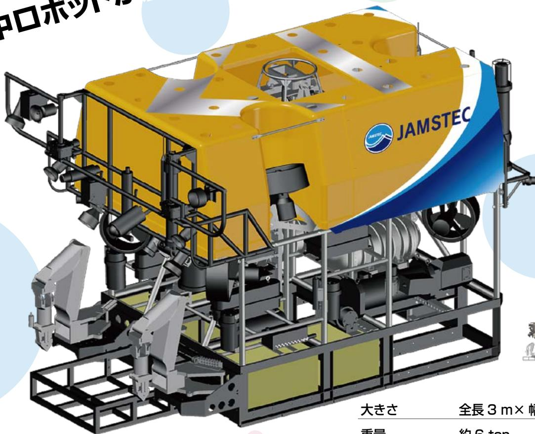
海洋鉱物資源の探査が可能なプラットフォームのひとつとして、海底鉱物探査機器を搭載し海洋資源の探査や研究を行うため、新たに大深度で重作業を行うことができる超高性能無人探査機(ROV: Remotely Operated Vehicle)を開発しました。このROVは、東日本大震災を引き起こしたような日本周辺に広がる深い海の底で、人々の安心・安全につながるような調査を行うこともできる世界トップクラスの性能を有しています。
