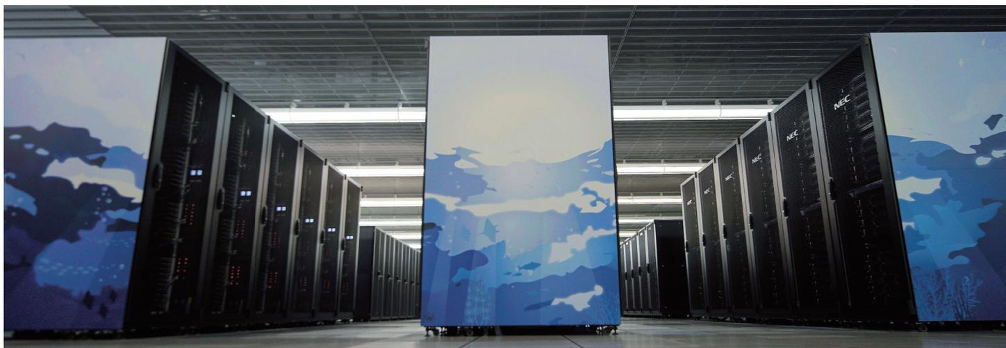
2021年3月より運用を開始した4世代目の「地球シミュレータ」は、アクセラレータを組み合わせたマルチアーキテクチャ型スーパーコンピュータで、米AMD社製CPUをベースに、日本電気株式会社製SX-Aurora TSUBASAや米NVIDIA社製GPU A100といったアクセラレータを組み合わせることで、従来研究のさらなる発展とAI研究など新規研究課題実施の両立を目指しています。
