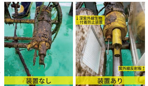
pH センサーに設置した深紫外線生物付着防止システム (約 2 か月間水中試験を実施した結果)
