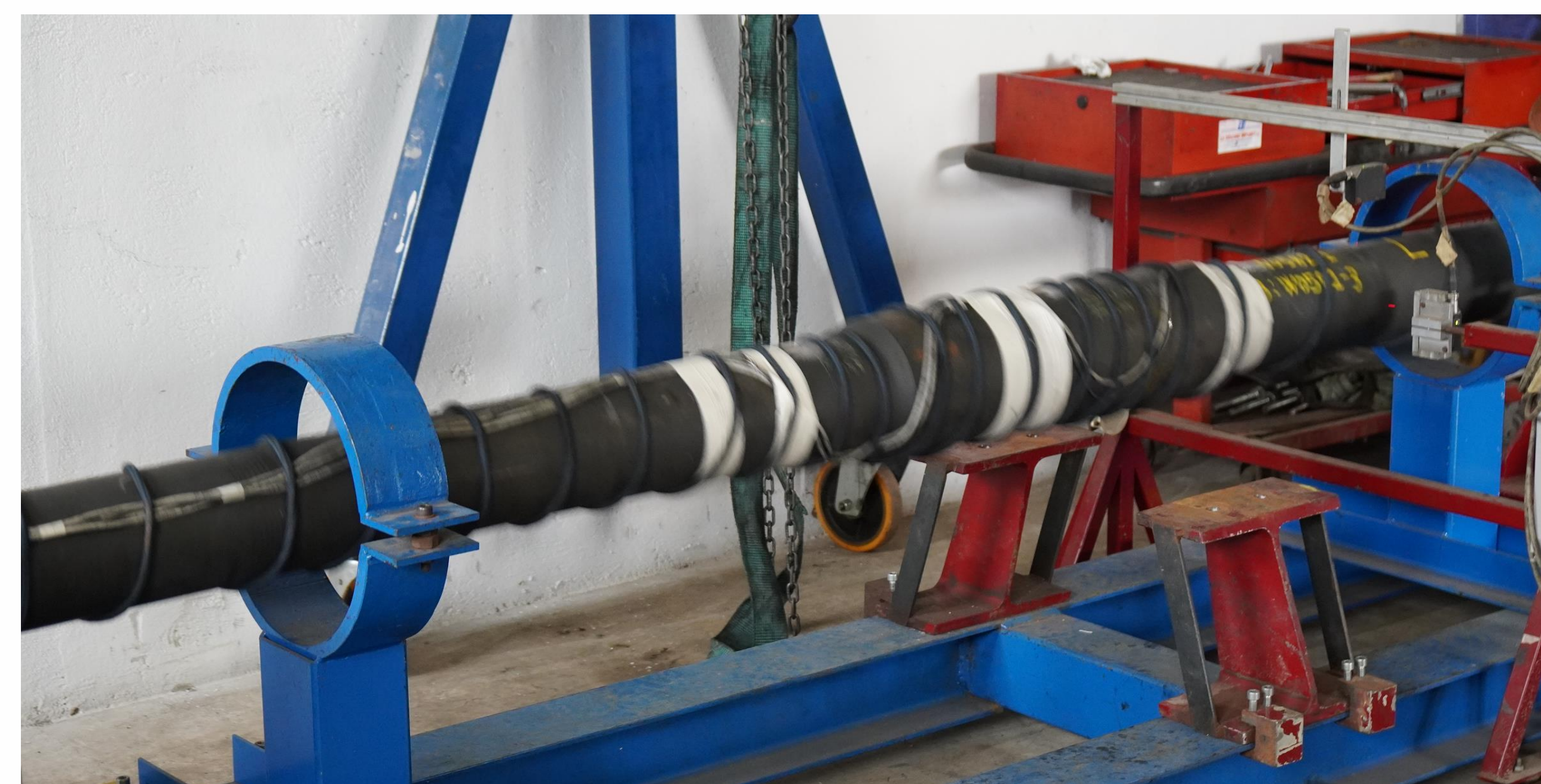
新コンセプトのドリルパイプ模型の疲労強度試験（評価用データ取得）
