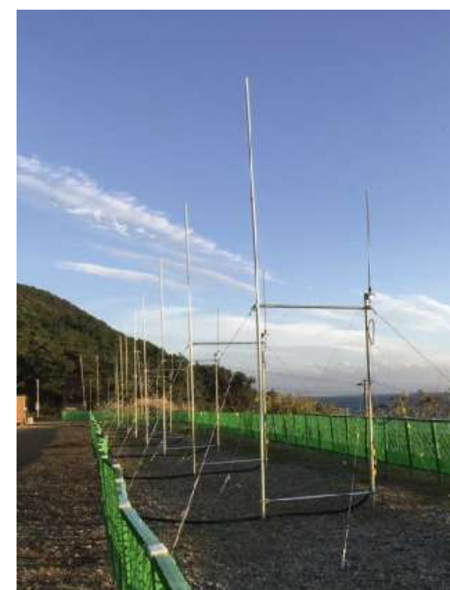
海洋短波レーダー (HFR) 汐首局 海面へと電波を発射し、反射してきた電波を解析することで、広域の表面流速分布を継続的にモニタリングすることができます。
