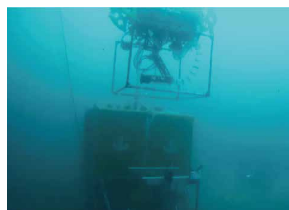
⑦ 小型 AUV のカメラでドッキング用マーカータラえて位置と方位を維持しつつ、ゆっくりと降下し、海底基地局にドッキング
