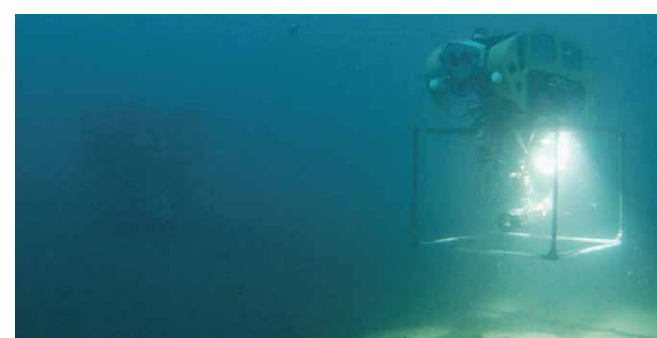
③ 小型 AUV は海底基地局から切り離され水平移動し調査を開始
